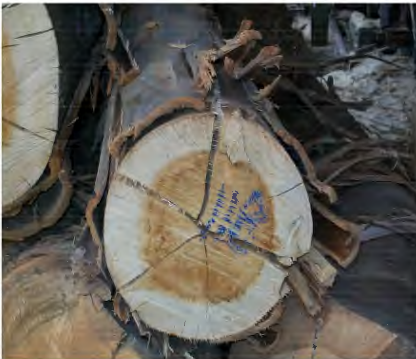
Figura 11: Rajadura en estrella
