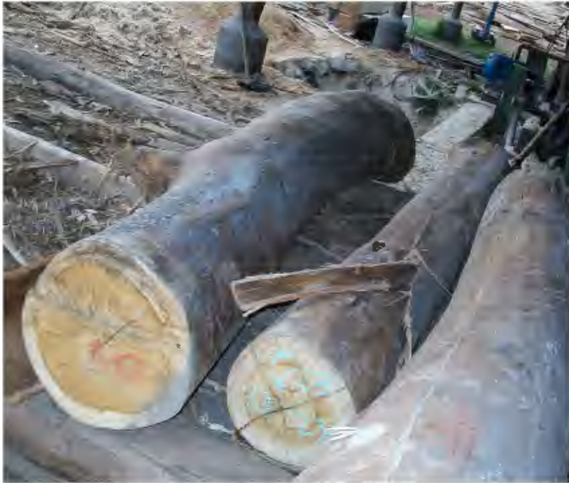
Figura 06: Fuste torcido, grietas en el extemos
