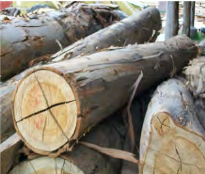
Figura 09: Rajadura en estrella, protuberancia en el fuste
