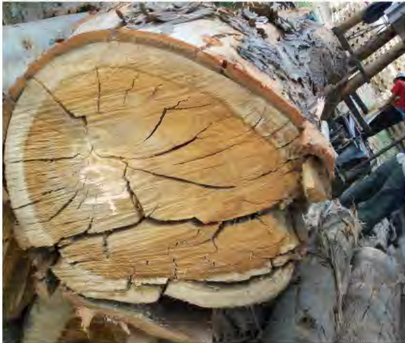
Figura 07: Rajadura en el extremo
