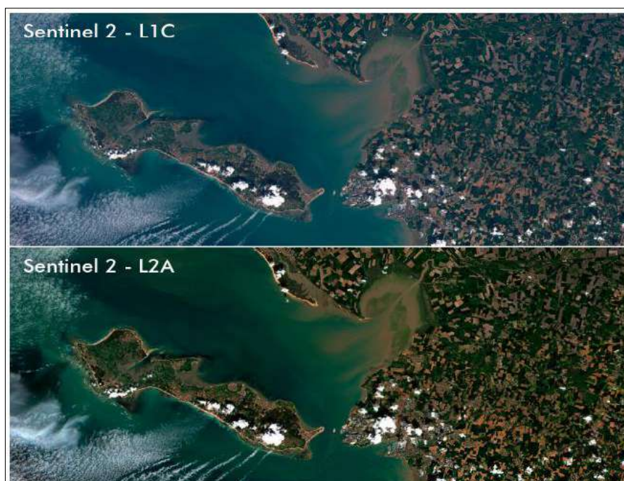
Figura 3. Diferencia entre imágenes Sentinel 2, nivel 1C y 2A.
