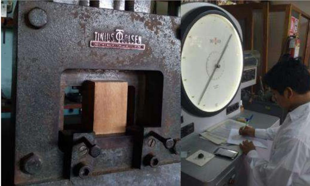
**Figura 9: Determinación de cizallamiento paralelo al grano**
