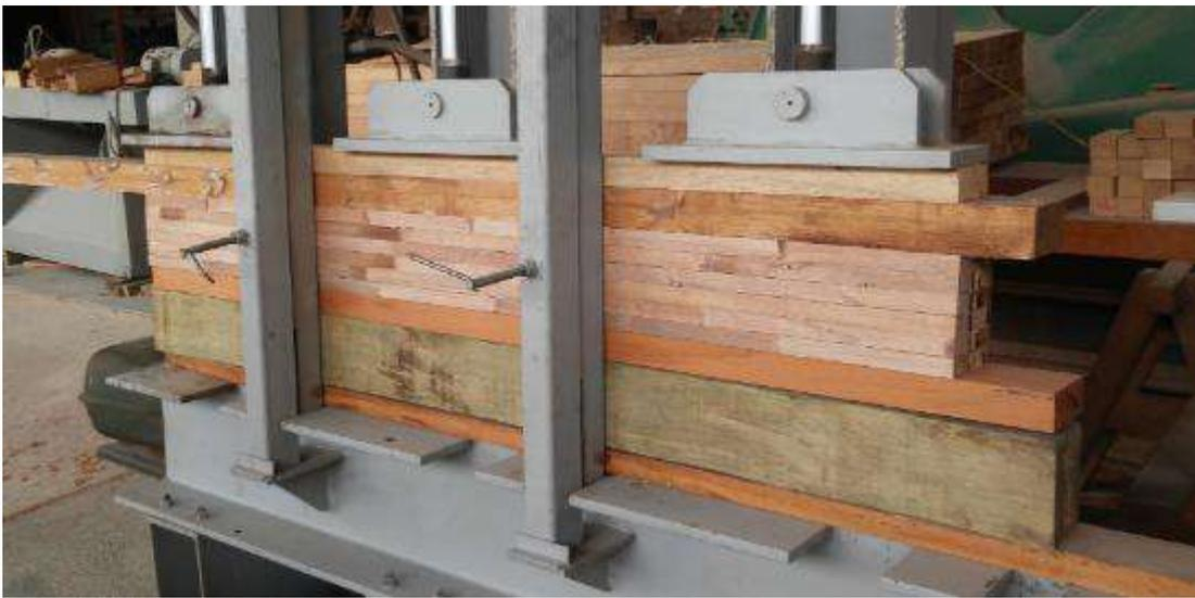
**Figura 22: Prensado de vigas laminadas**
