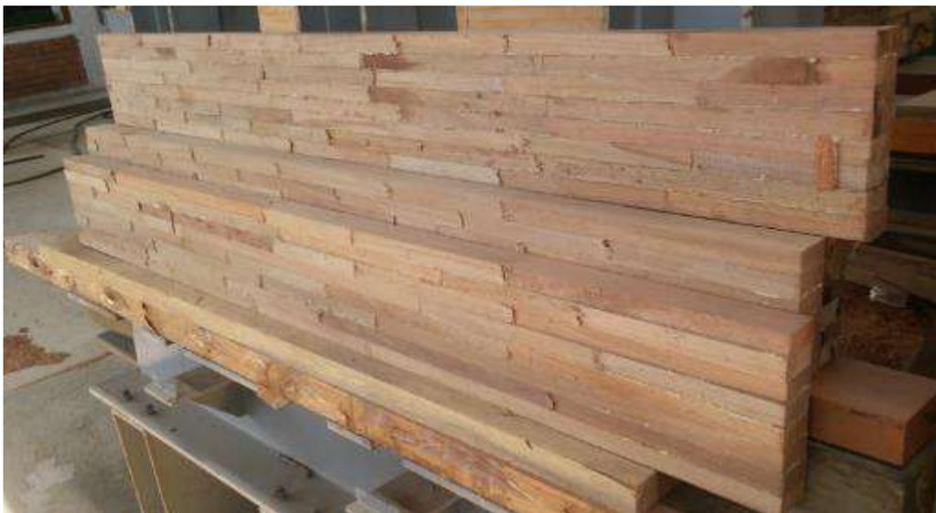
**Figura 23: Vigas laminadas en proceso de fraguado**
