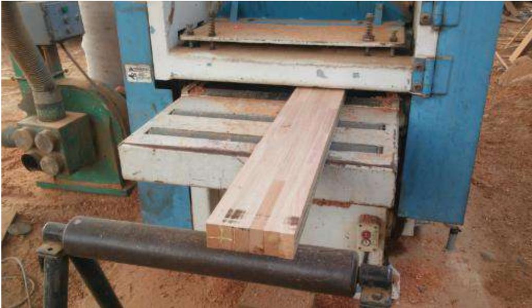
**Figura 24: Cepillado de vigas laminadas**
