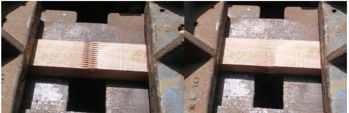
**Figura 17: Juntado de empalmes finger joint**
