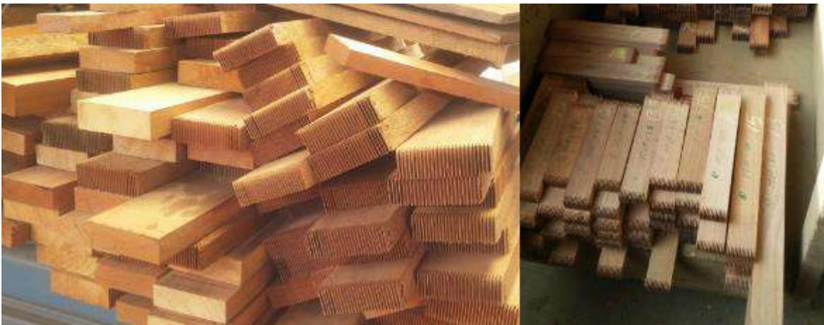
**Figura 12: Extremos de tablas con empalmes finger joint**
