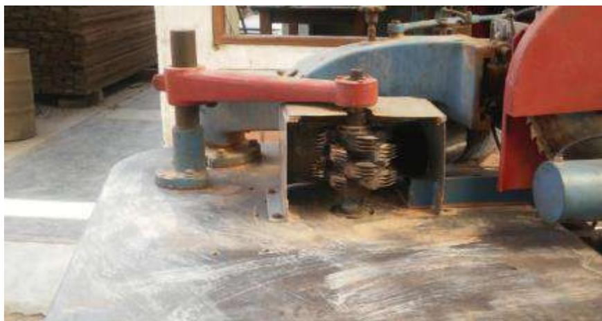
**Figura 14: Fresa de máquina formadora de empalmes finger joint**
