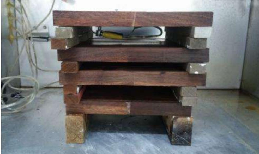
**Figura 28: Secado de probetas en horno experimental**
