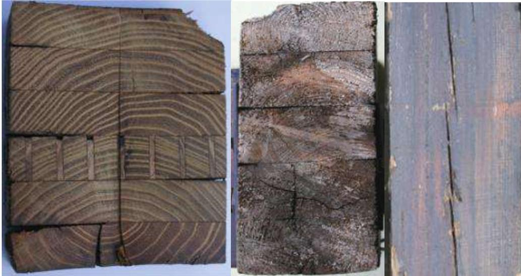
**Figura 4: Severas delaminaciones y fracturas en elementos estructurales con más de 34 años de servicio**
