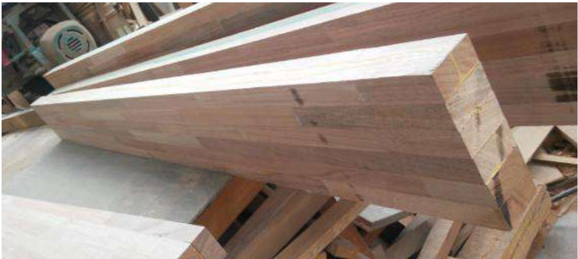
**Figura 25: Vigas laminadas acabadas**
