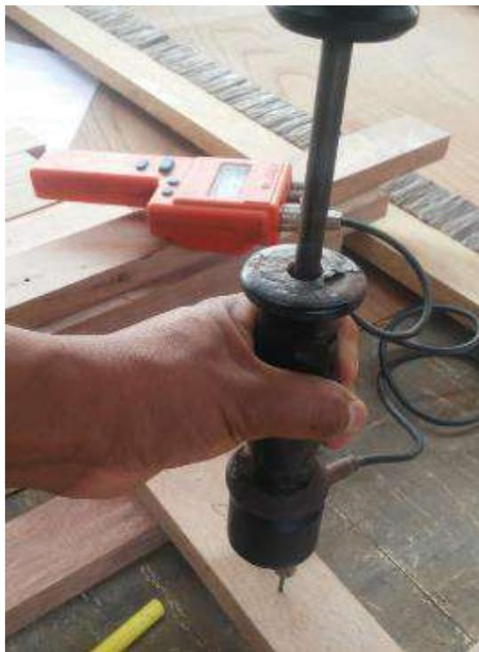
**Figura 11: Medición de contenido de humedad con higrómetro de pines**
