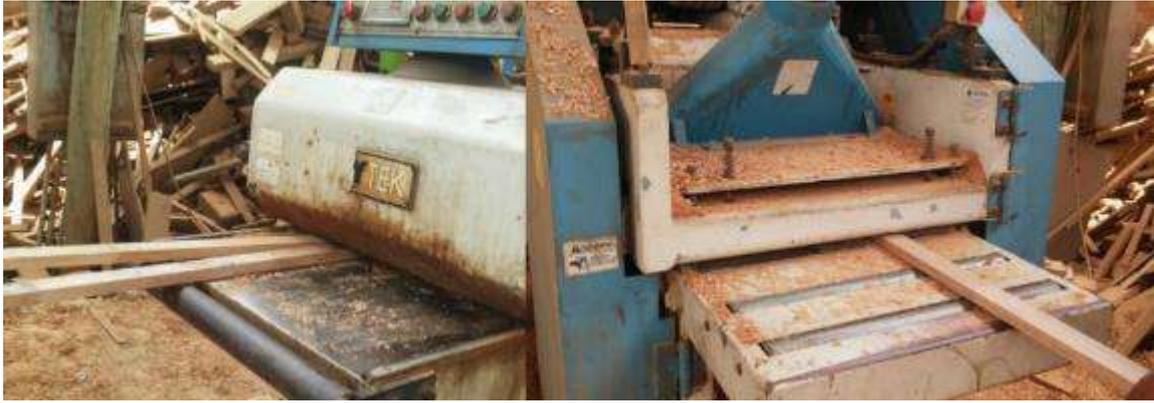
**Figura 20: Cepillado de láminas unidas con empalmes finger joint**
