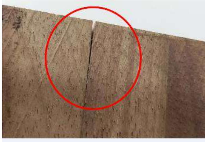
**Figura 51: Delaminación en un plano de encolado**
