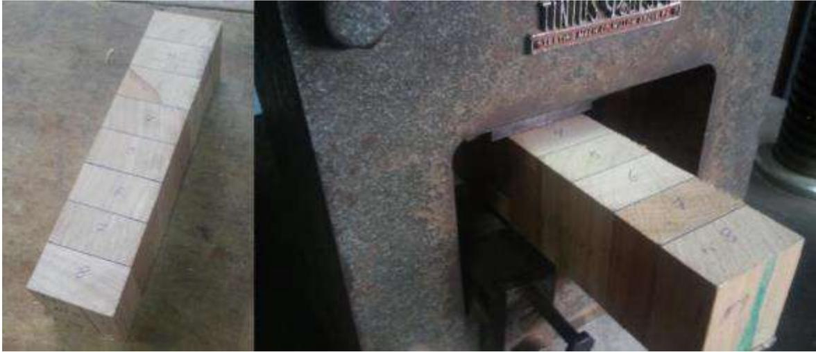
**Figura 30:** Dimensiones de probetas para ensayo de esfuerzo cortante en los planos de encolado
