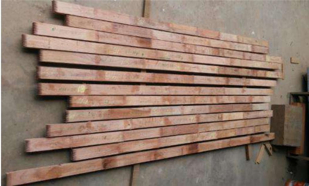
**Figura 19: Periodo de “curado” de láminas con empalmes finger joint**
