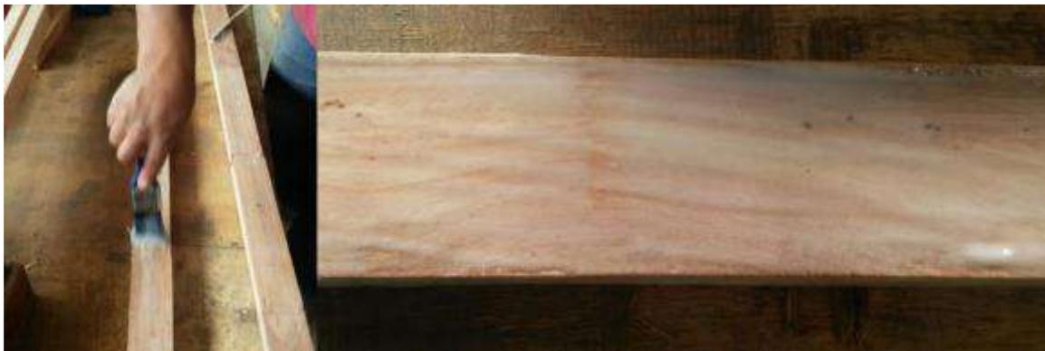
**Figura 21: Forma de encolado de láminas en sus caras**
