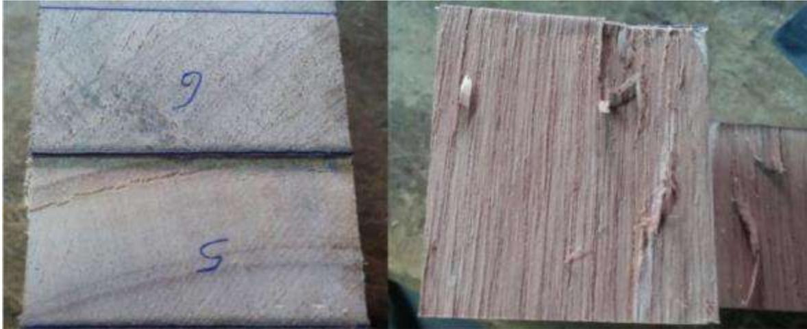
**Figura 40: Fallo de madera en probeta ensayada en esfuerzo cortante**
