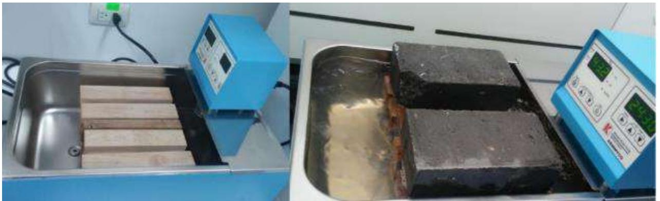
**Figura 27: Probetas antes y durante el ensayo con agua hirviendo**
