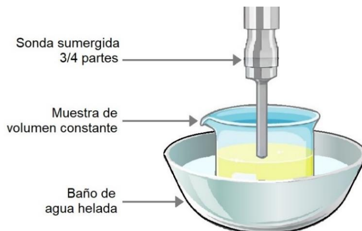
Figura 5: Esquema del sistema de trabajo en el tratamiento de ultrasonido
