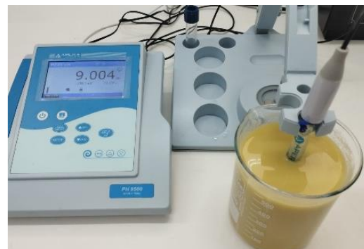
2 Alcalinización de la disolución de harina de tarwi
