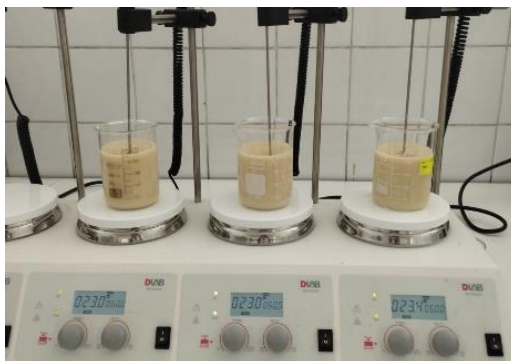
3 Homogeneización en caliente de la disolución alcalina
