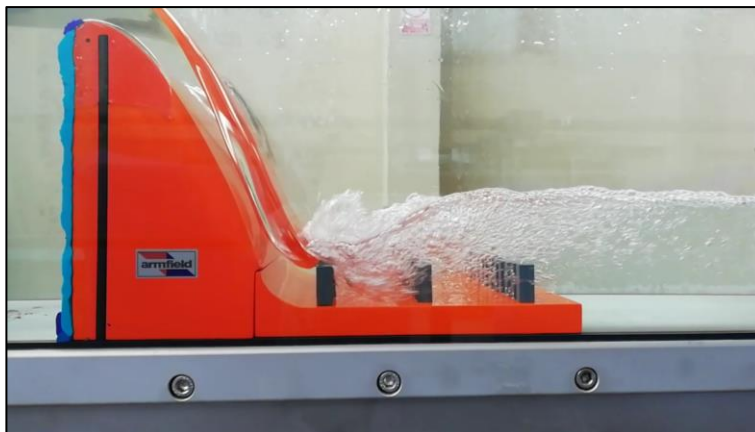
Figura 35: Vista del Disipador C, Salto Hidráulico Q = 8.5 l/s
