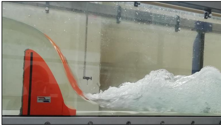
Figura 18: Disipador Spillway Toe: A
