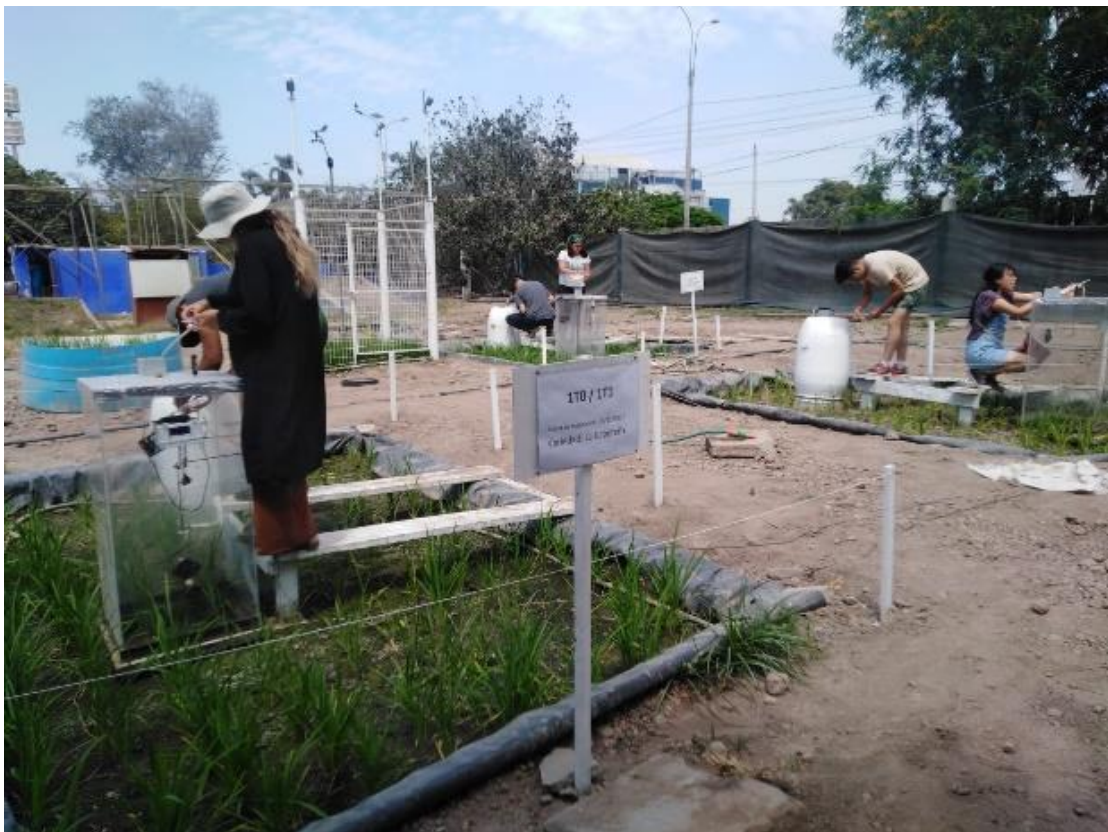
f. Monitoreo GEI mediante cámaras estáticas
