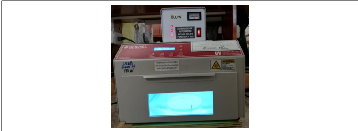
Figura 15. Equipo reticulante emisor de radiación UV utilizado para los ensayos de fotoprotección. Este tipo de equipos, es generalmente usado para la reticulación de ADN o ARN inmovilizado en membranas de nylon y otros. Sin embargo, debido a que provee dosis precisas de radiación UV, es también utilizado para los ensayos de resistencia o sensibilidad. En este caso, el equipo es del modelo 23410 de la marca Boekel Scientific y utiliza una lámpara UV de 306 nm (UVB).
