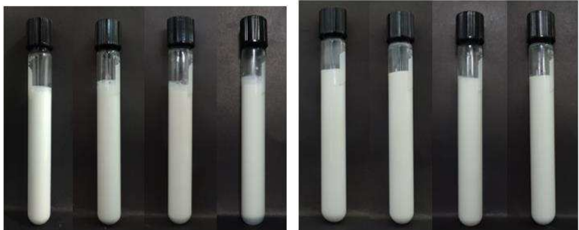
Figura 30: Emulsiones Pickering preparadas con almidones BM-OSA 30% y 50% días 0, 1, 14 y 28 (izquierda a derecha)
