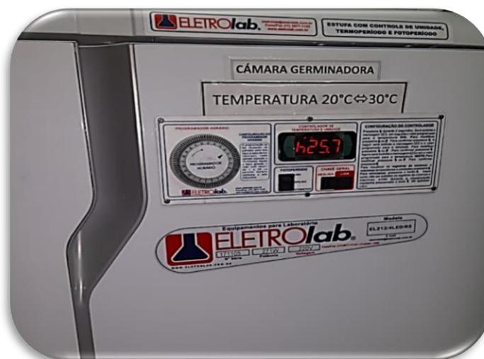
**Figura 9:** Cámara Germinadora de semillas a temperatura de  $20\text{ }^{\circ}\text{C} \leftrightarrow 30\text{ }^{\circ}\text{C}$ .
