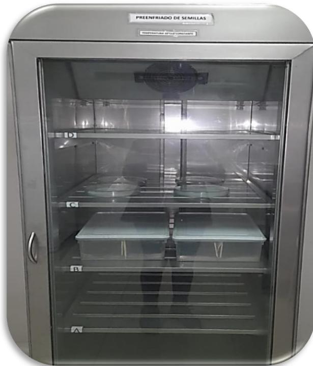
**Figura 7:** Cámara de Pre enfriamiento de semillas a temperatura de  $10\text{ }^{\circ}\text{C} \pm 2\text{ }^{\circ}\text{C}$ .
