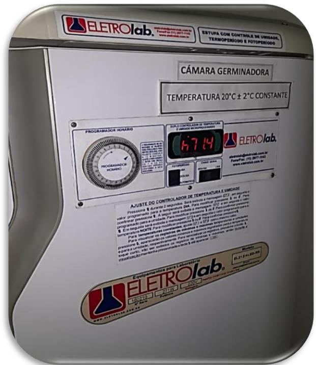
**Figura 8:** Cámara Germinadora de semillas a temperatura de  $20\text{ }^{\circ}\text{C} \pm 2\text{ }^{\circ}\text{C}$ .
