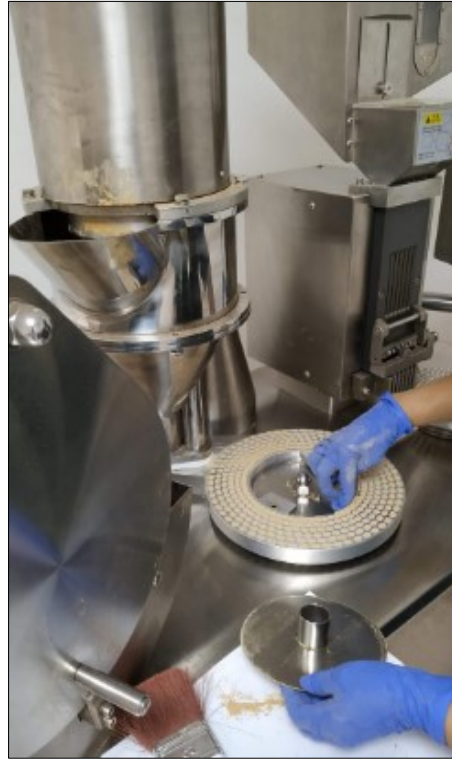
Retiro del molde con cápsulas para la expulsión de cápsulas
