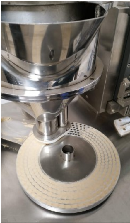
Etapa de dosificación de Harina de Maca en el cuerpo de las cápsulas
