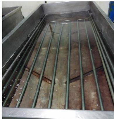
En un plazo de una hora aproximadamente el agua llega a una temperatura de 97° C, es ahí donde se comienzan a vaciar las cajas completando así un total de 20, con un peso aproximado de 500 kg.
