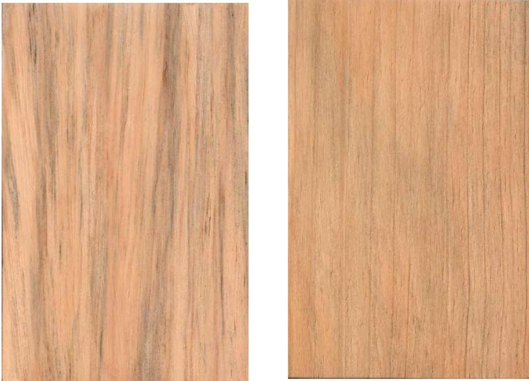
**Figura 4: Madera en corte tangencial y radial**
