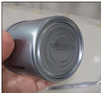
En casos de encontrar presencia de oxidación, golpes, códigos poco visibles o defectos en el área del sellado, etc., se procede a describir el defecto detectado y la cantidad de unidades afectadas. En la NTP 204.007 2019 hace referencia alguno de estos defectos.
