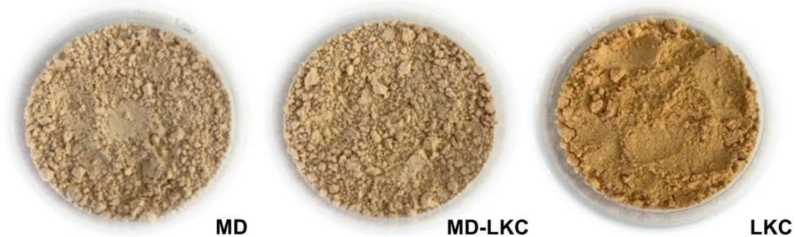
**Figura 42: Micropartículas de ESPC formadas por atomización con los diferentes materiales de pared**
