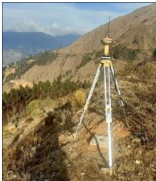
Figura 13: Punto geodésico tramo de conducción proyectado Yanas 01
