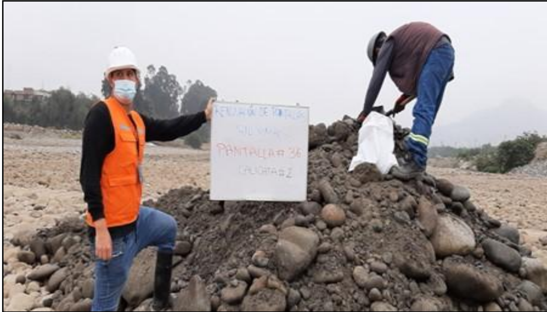
Figura 25: Obtención del material arenoso gravoso GP (Pantalla N°36)
