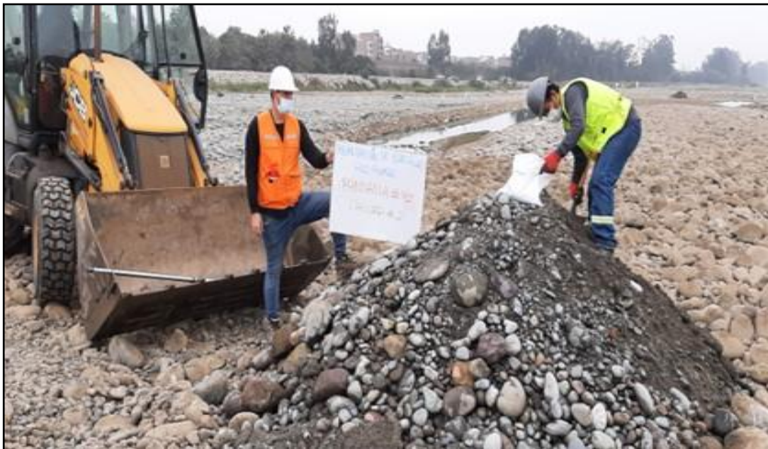
Figura 24: Obtención del material areno gravoso GP (Pantalla N°06)
