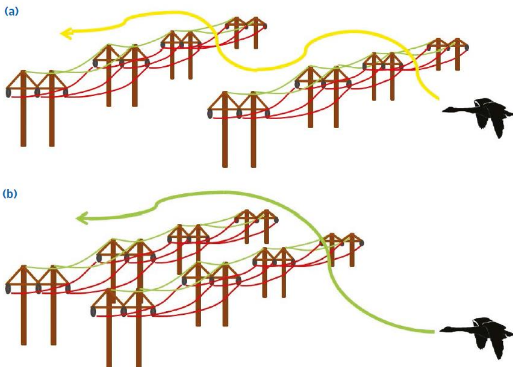
Figura 15. Reducción de riesgo de colisión al agrupar líneas de transmisión
