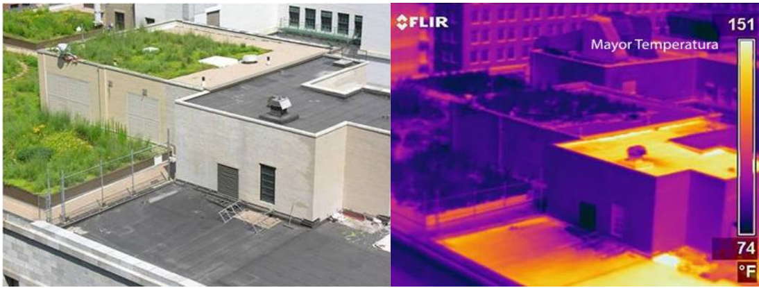
Figura 8: Las cubiertas vegetales amortiguan el efecto de temperatura en las edificaciones.
