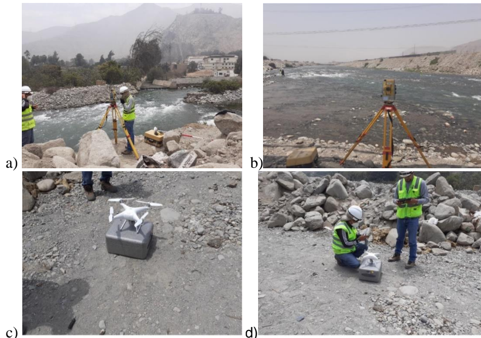
Figura 11. Levantamiento topográfico convencional y fotogramétrico a) y b) Fotografías de levantamiento topográfico convencional en el cauce c) y d) Fotografías de levantamiento fotogramétrico en la zona aledaña del cauce
