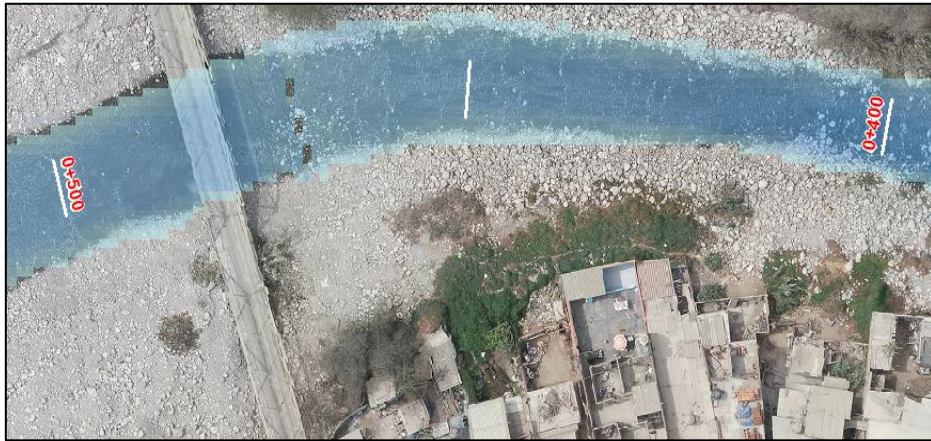
Figura 28. Tramo 0+400 a 0+500 km – Epoca de estiaje con mancha de agua generada
