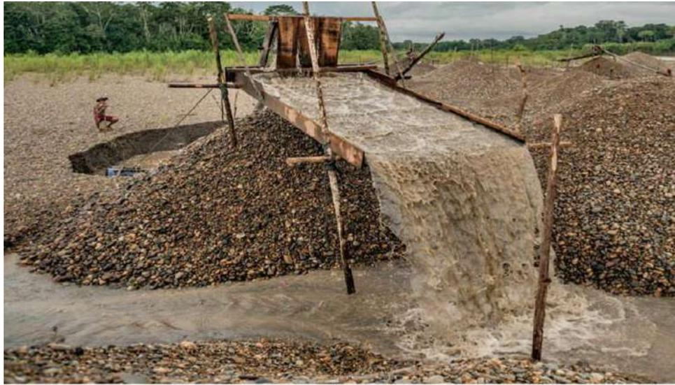
**Figura 5: Utilización de bomba de succión y generación de montículos de gravas durante la actividad de minería aurífera aluvial**
