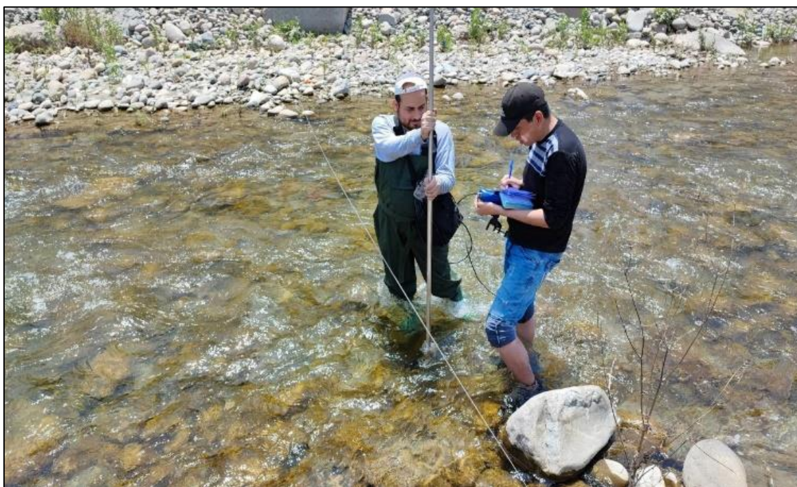
Figura N° 33: Aforo de caudal Prog.1+000 - Método de vadeo
