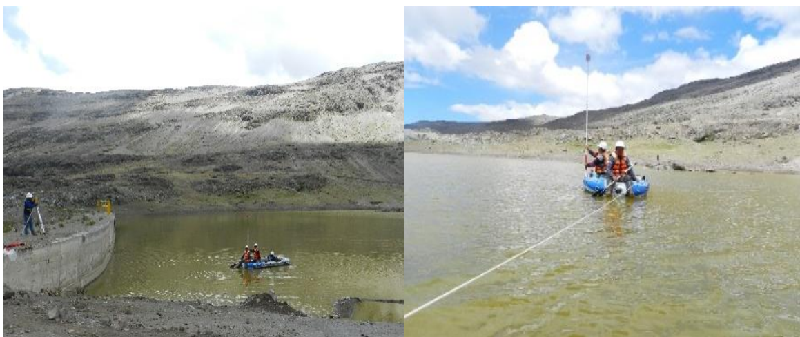
Figura 20: Levantamiento batimétrico y topográfico en la laguna Huitama.
