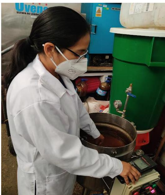
**Figura 25.** Medición de pH
