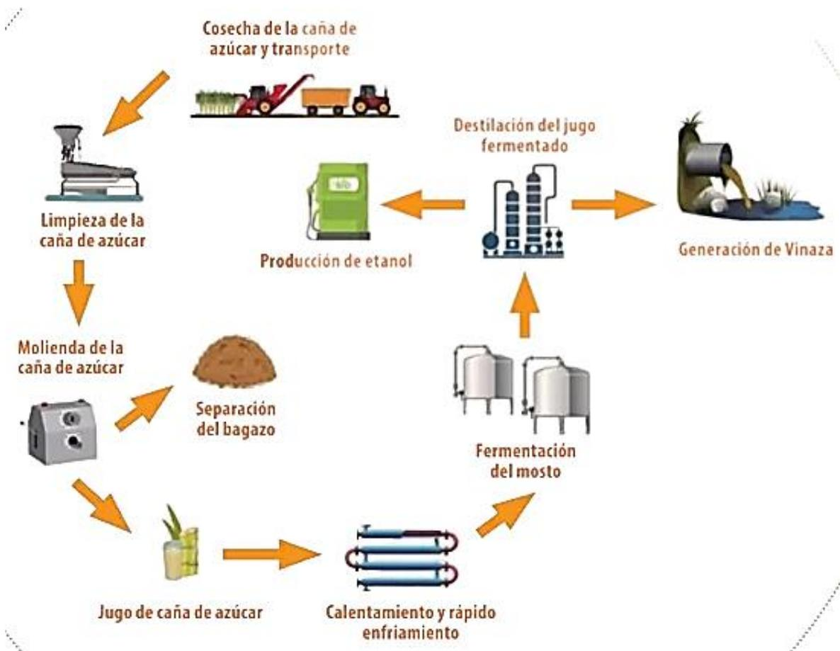
**Figura 5.** Proceso de obtención de las vinazas de la caña de azúcar.
