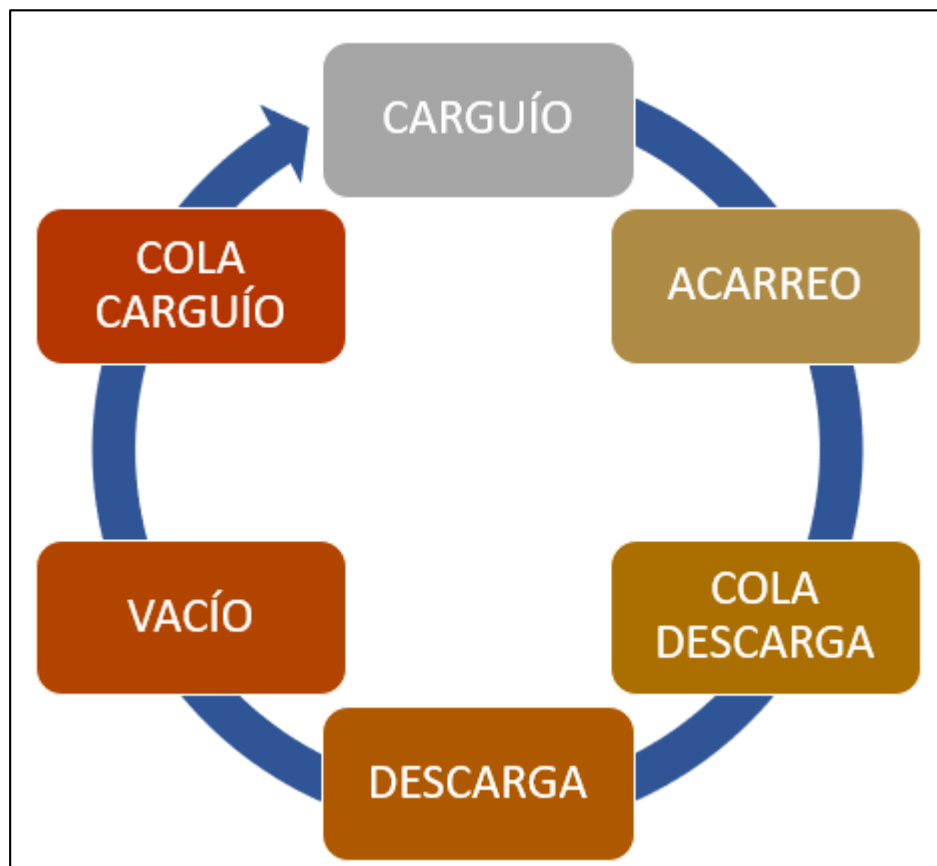
Figura 9: Proceso dentro del movimiento de tierras
