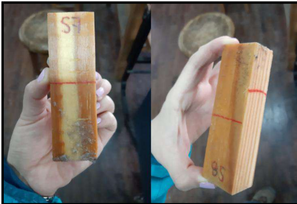
Anexo 23: Probetas sin tratamiento (prueba control) con indicios de moho negro posterior a la prueba de hincharse por 7 días
