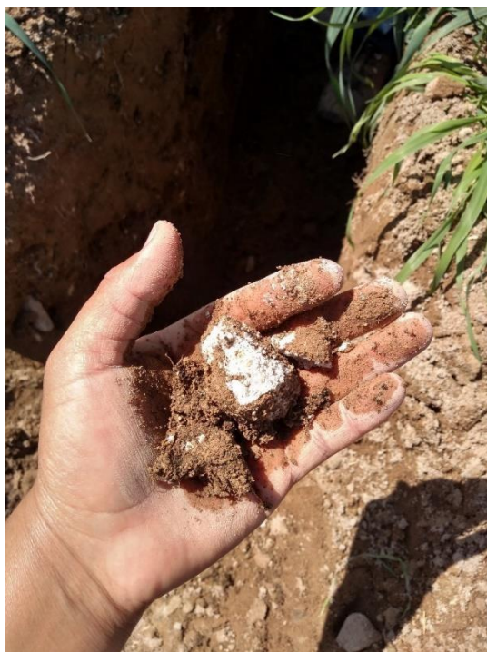
Figura 22: Desprendimiento entre partículas del caliche por acción de azufre
