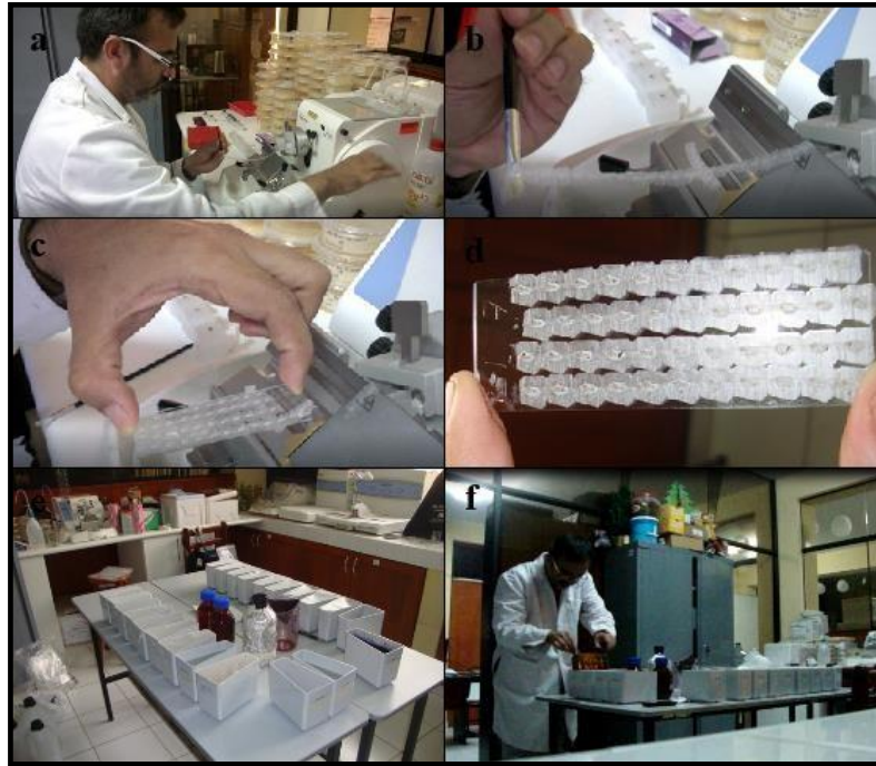
Figura 3. (a, b, c, d): corte de los bloques de parafina en el Micrótopo de rotación ThermoSCIENTIFIC – Micrón HM 325 y montaje en láminas porta objeto (e y f) batería y proceso de tinción con hematoxilina-eosina
