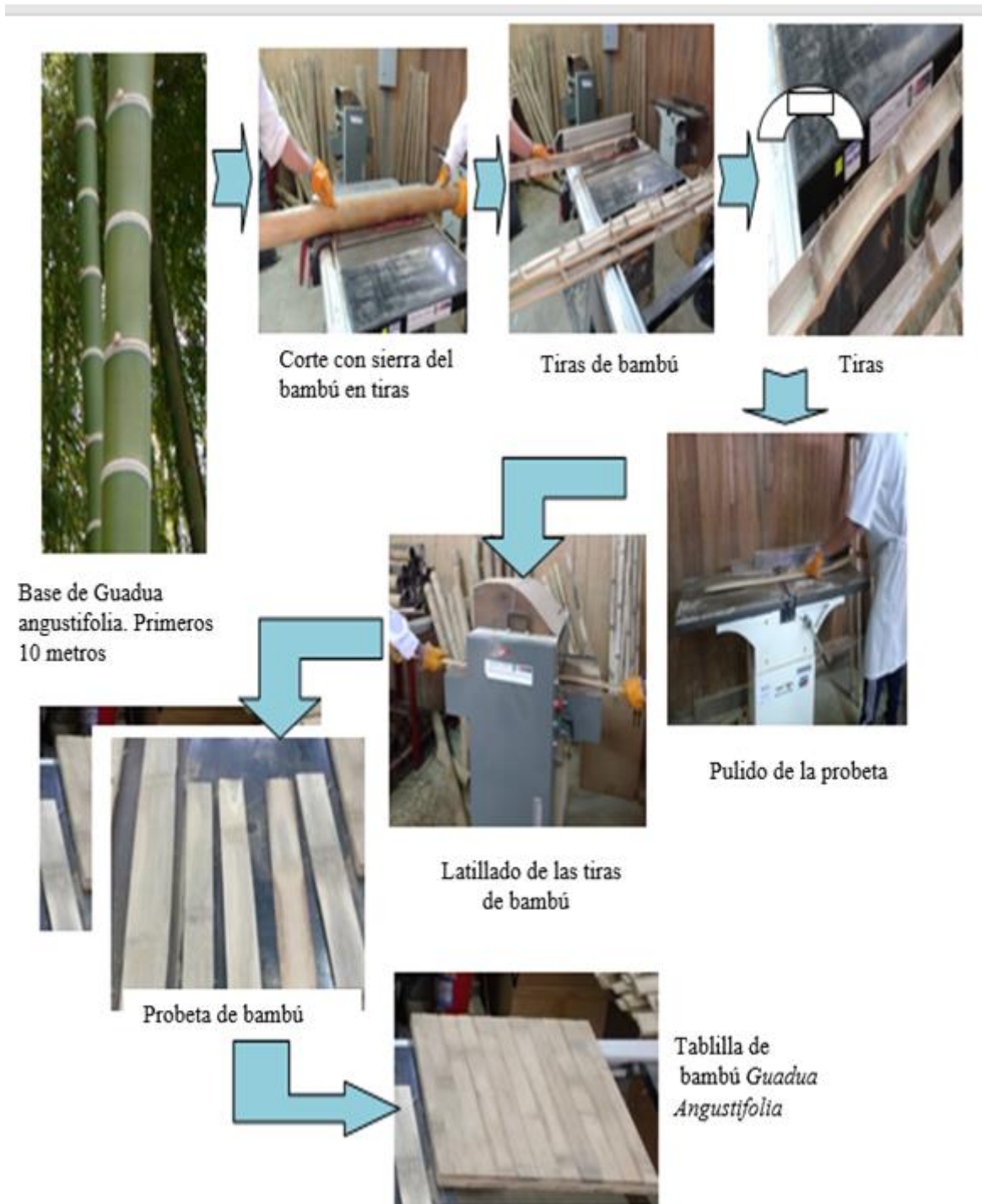
Figura 21: Esquema de producción de una tablilla de bambú Guadua angustifolia
