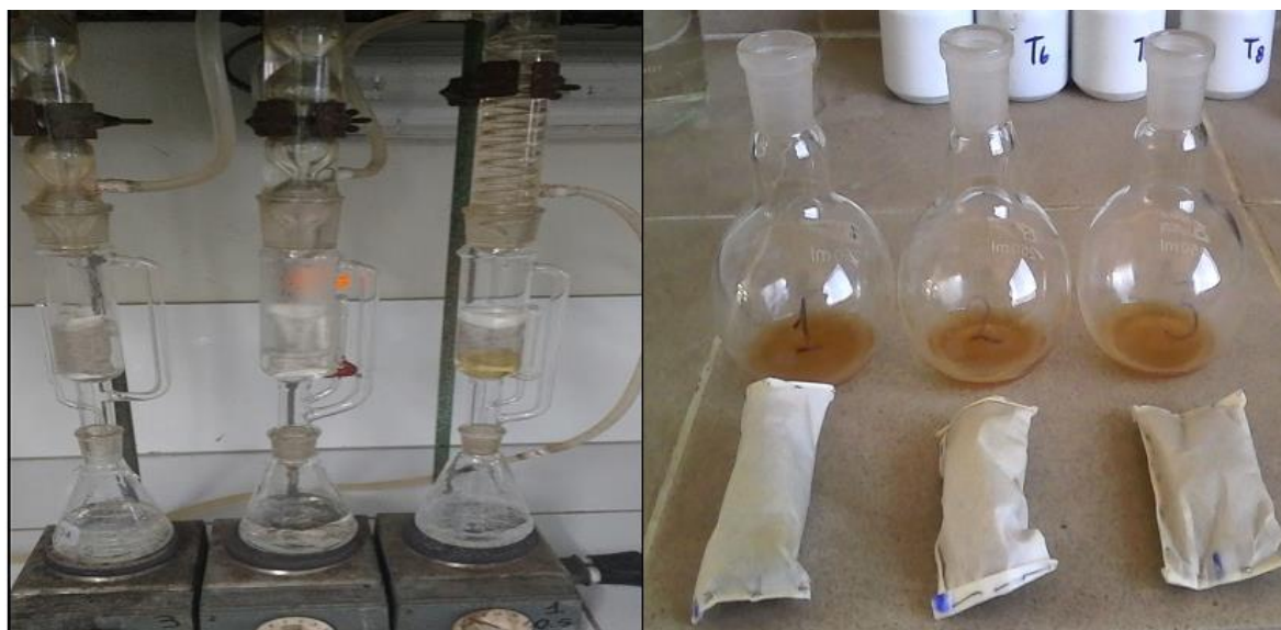
Figura 57: Acondicionamiento de la muestra (Extracción de aceites y grasas) - Extracción con solvente - Metodología ASTM D1105-07
