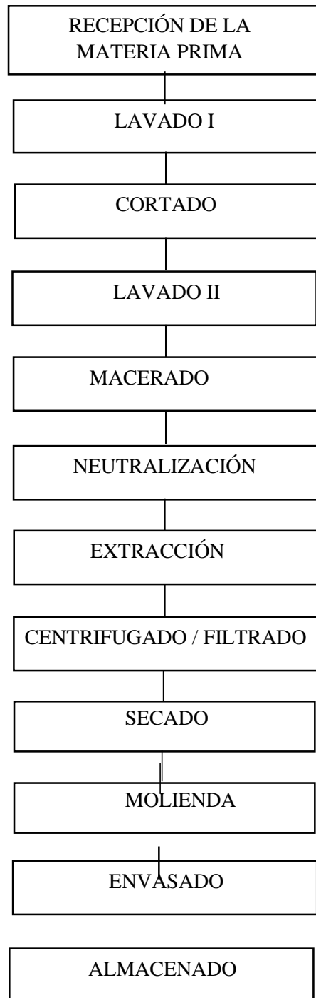
Figura 9: Flujo general para la obtención de colágeno a partir de cabeza de paiche
