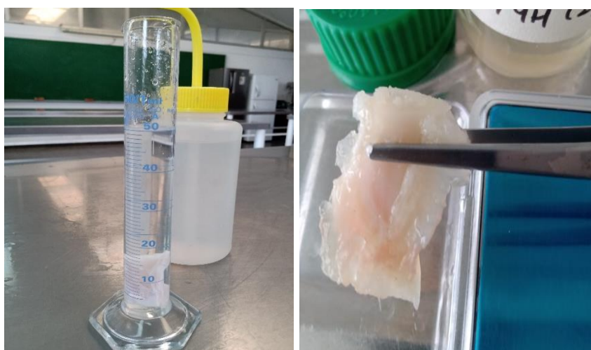
Figura 10: Medición de índice de hinchamiento en muestras con tratamiento con solución KOH 1 N
