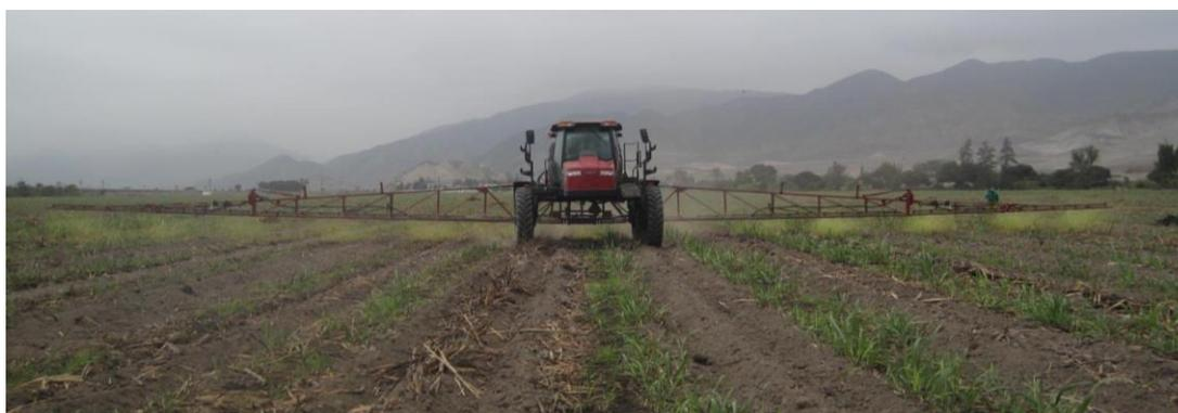
**Figura 33: Pulverizadora realizando la aplicación de un pre-emergente**
