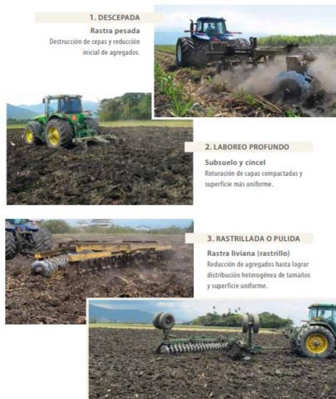
**Figura 6: Labores durante la preparación de terreno**
