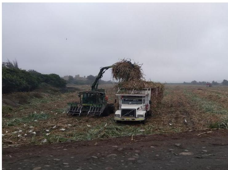
**Figura 55: Alce de caña cortada en verde, con alzadora**
