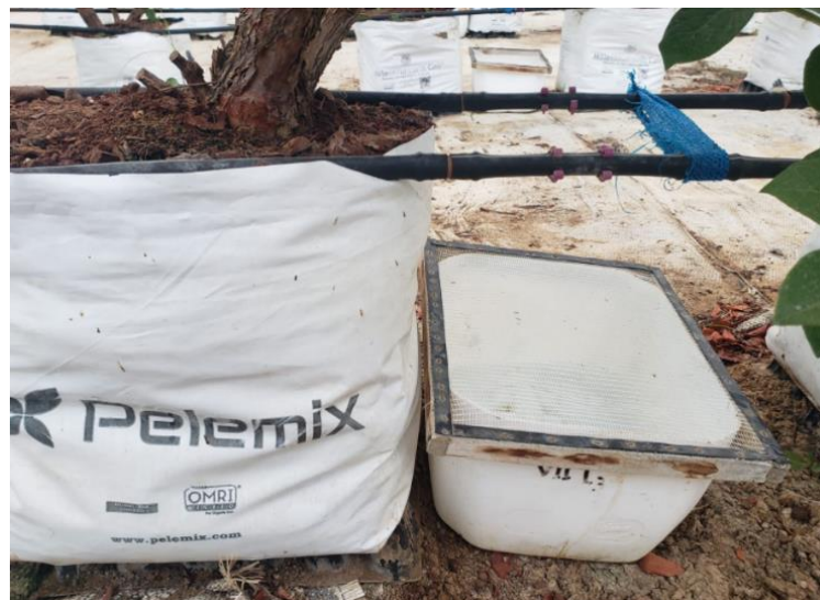
Figura 22: Lisímetro ubicado debajo del gotero control
