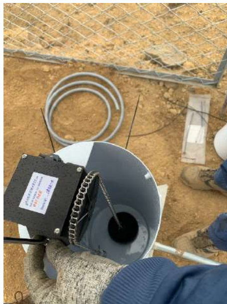
Figura 49. Mecanismo del sensor automático del tanque evaporímetro
