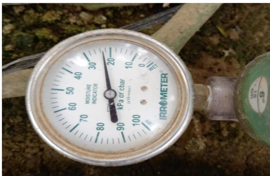
**Figura 20: Vacuómetro del tensiómetro**
