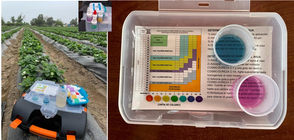
Figura 12: Kit empleado en campo para medición de pH y dureza del agua.
