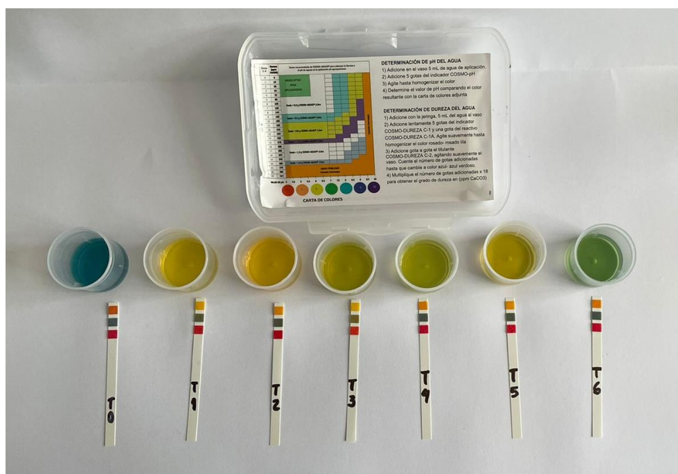
Figura 18: Prueba colorimétrica de pH para cada uno de los tratamientos evaluados en el ensayo comparativo de acidificantes/ablandadores en el mercado
