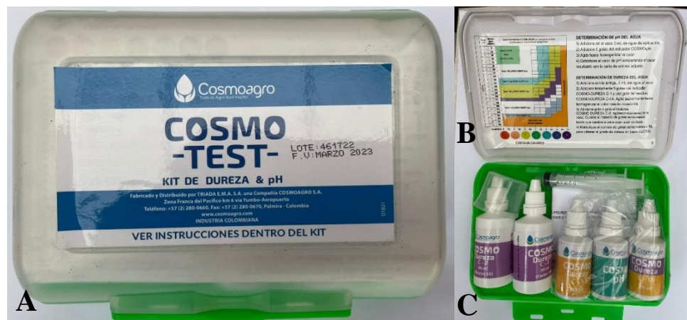
Figura 10: Foto frontal e interna del COSMO TEST ®, y su contenido. Nota: A) Parte frontal del kit, B) Parte interna del kit, C) Contenido del kit.
