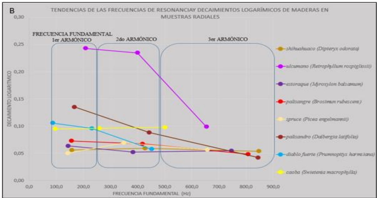
Figura 33: A: Relación entre frecuencias de resonancia y decaimientos logarítmicos en muestras radiales para la frecuencia fundamental (1 er armónico), 2 do y 3 er armónico. B: Tendencias.
