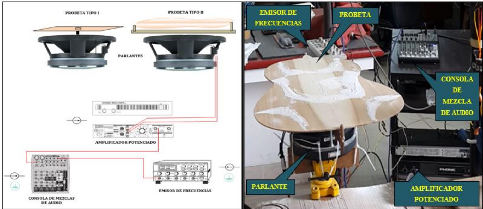
Figura 14: A: Diagrama de instalación del equipo de medición para modos de vibración. B: Equipo instalado en funcionamiento.
