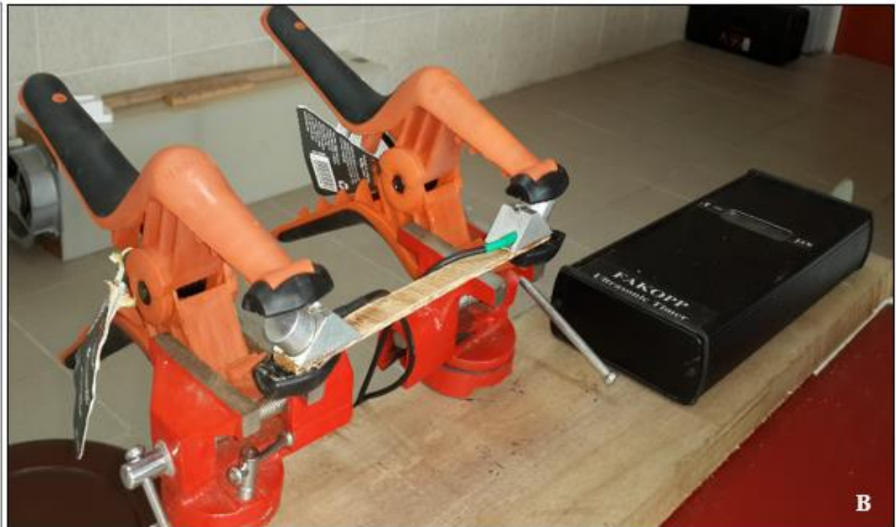
Figura 9: Diagrama de instalación del equipo de medición de velocidad de sonido. B: Equipo instalado en funcionamiento.
