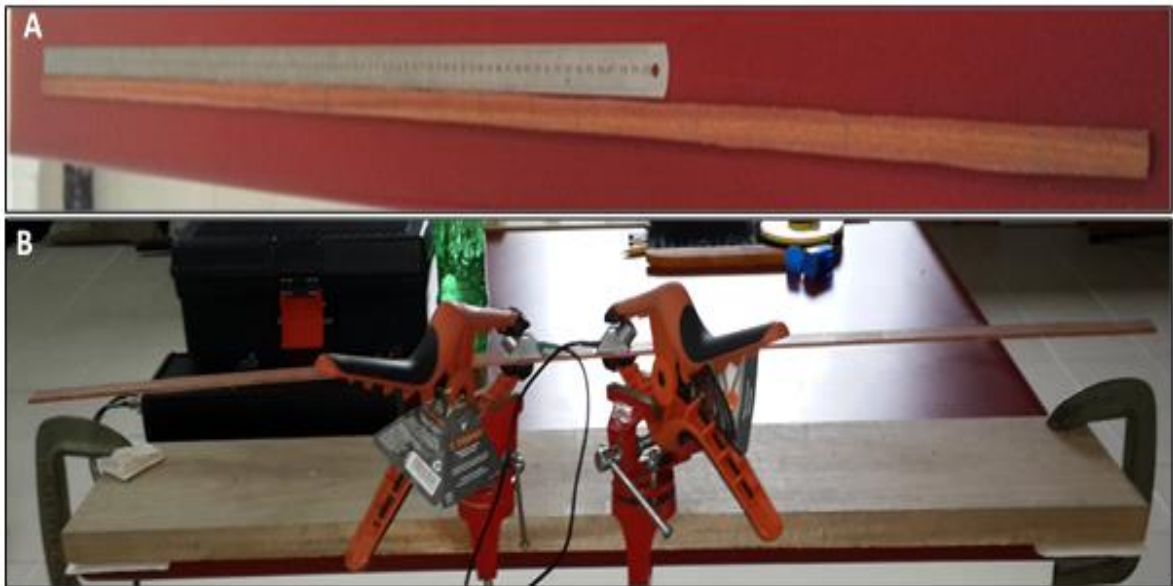
Figura 8: A: Listón de madera para calibración. B: Equipo de calibración instalado.
