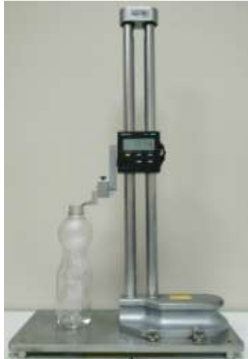
Figura 12. Medición de altura de envase con equipo medidor de altura digital
