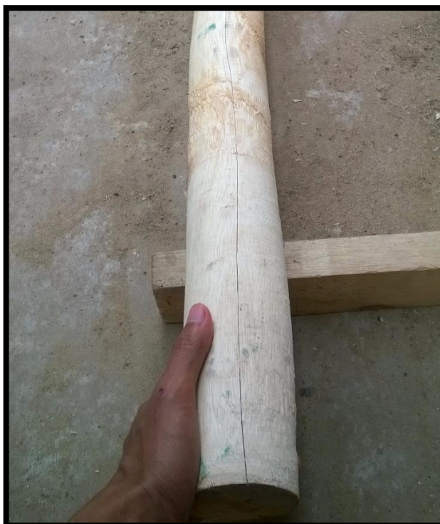
Figura 10. Grietas en la superficie de poste de bolaina, producto de las tensiones ocasionadas durante el secado. Empresa Maquiwood S.A.C.
