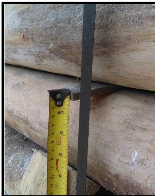
Figura 4. Separadores de espesor inadecuado, empleados en operaciones de secado iniciales, antes de capacitaciones en la empresa Maquiwood S.A.C.
