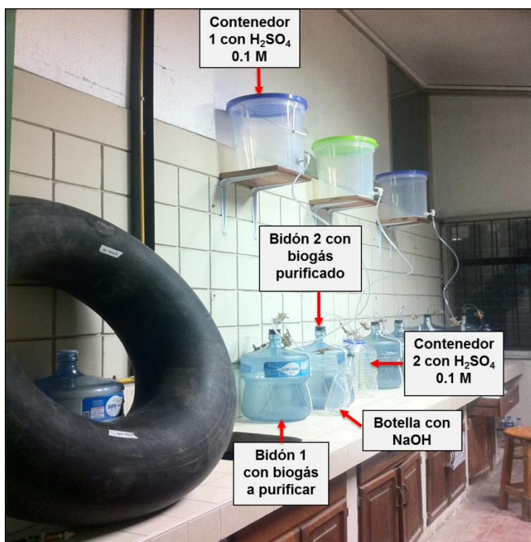
Figura 4: Sistema del equipo purificador de biogás. Diseño propio.
