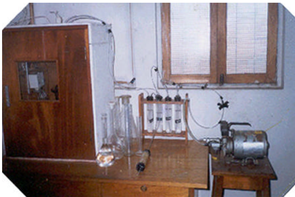
Figura 2: Equipo para la determinación del calor de respiración de frutas y hortalizas (Montes, 1998)
