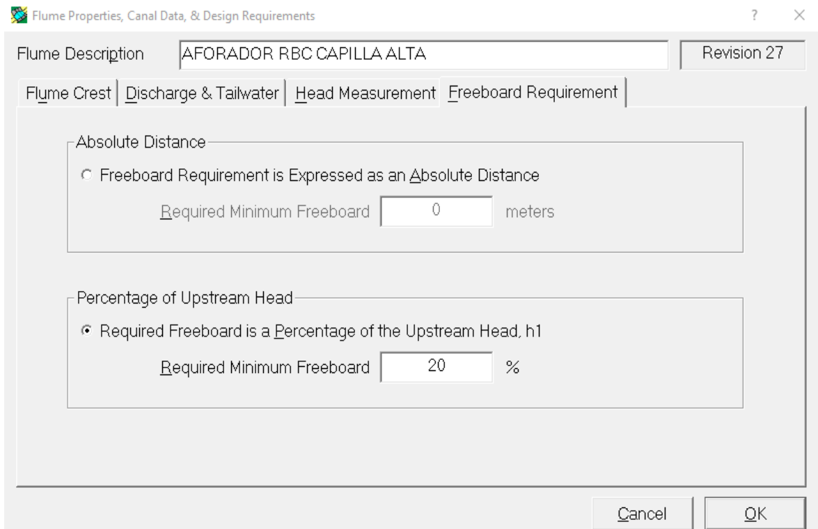
Figura 26. Criterio de borde libre para el diseño del aforador aplicando WinFlume
