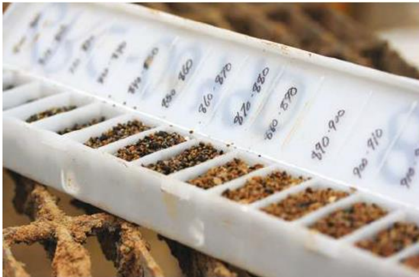
Figura 4: Muestras obtenidas mediante sondaje de Aire Reverso
