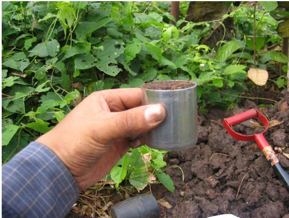
Remoción del exceso de suelo nivelando los bordes del cilindro
