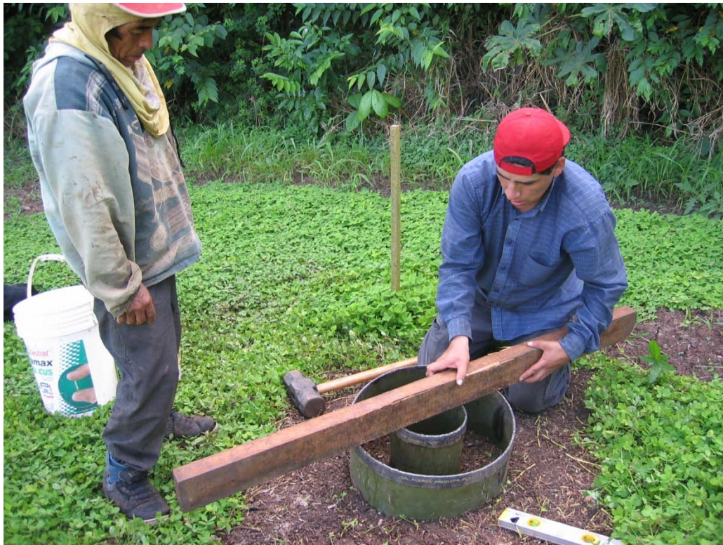
Instalación de los cilindros (externo e interno) para estimar la infiltración
