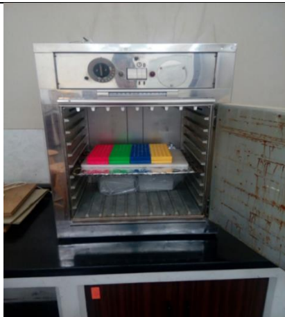
Figura 5 a: Muestras dispuestas para secado en estufa. b: Muestras encapsuladas. Fuente: (University of New Mexico Center for Stable Isotopes, http://csi.unm.edu/sample_submission/preparation )
