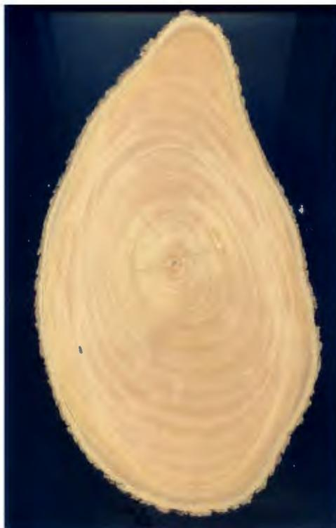
**Figura 3** Corte Transversal de Sapote en condición seca.
