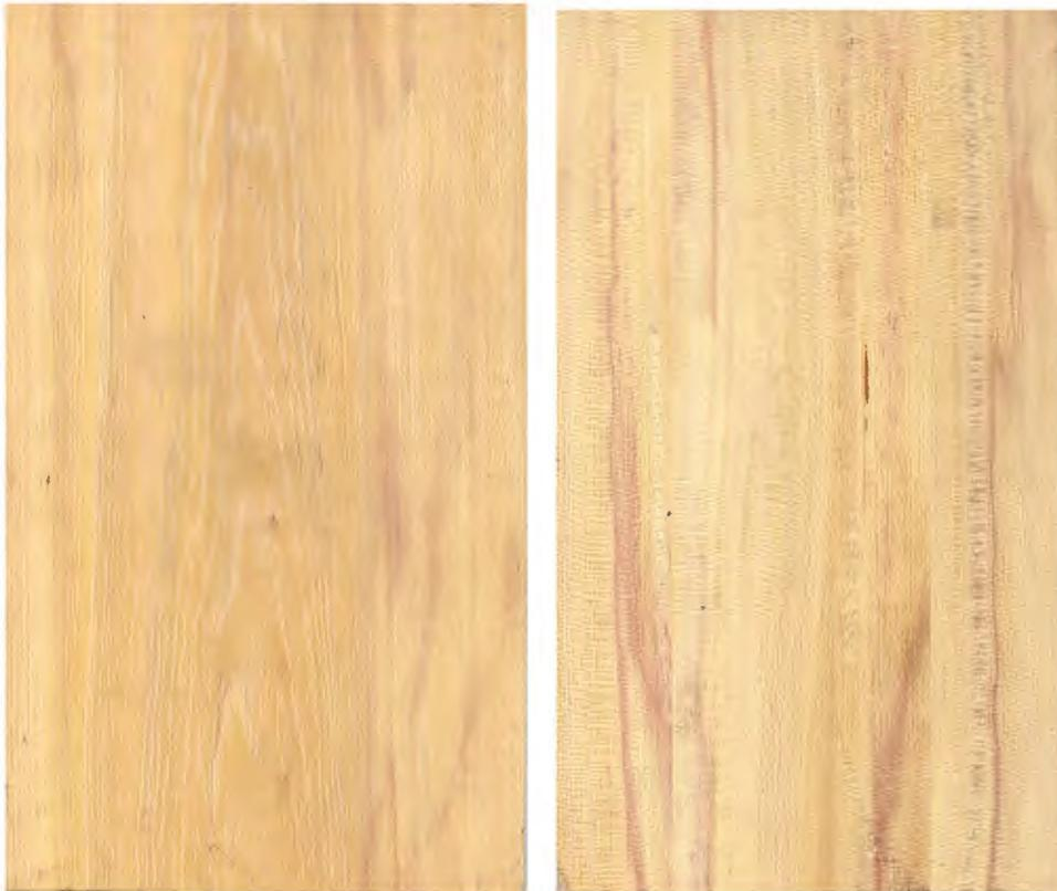
**Figura 4** Corte Tangencial y Radial de la madera de Sapote.
