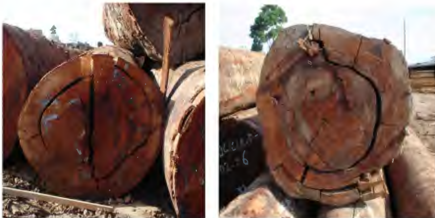
Figura N° 2 y 3: Diferentes formas de acebolladura
