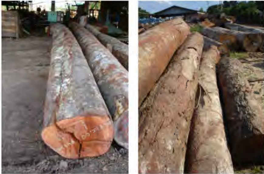
Figura N° 1. Torcedura con rajadura en estrella
