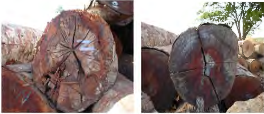
Figura N° 7 Diferentes formas de grietas en las trozas de Copaiba
