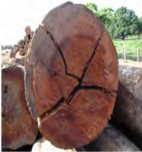
Figura N° 4 y 5: Diferentes formas de rajadura
