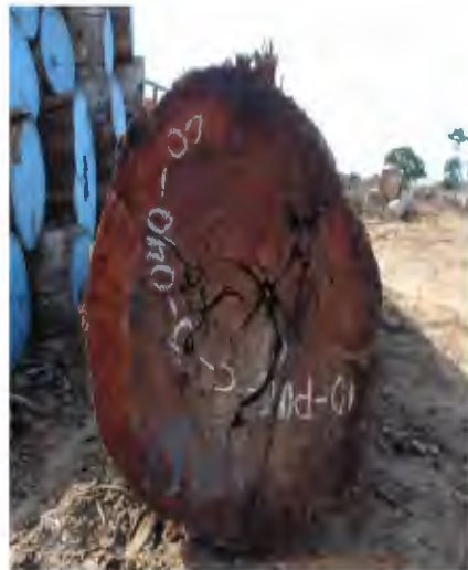
Figura N° 6: Un caso atípico de baleado en la Copaiba.
