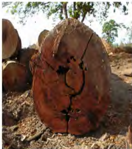
Figura N° 6: Un caso atípico de baleado en la Copaiba.
