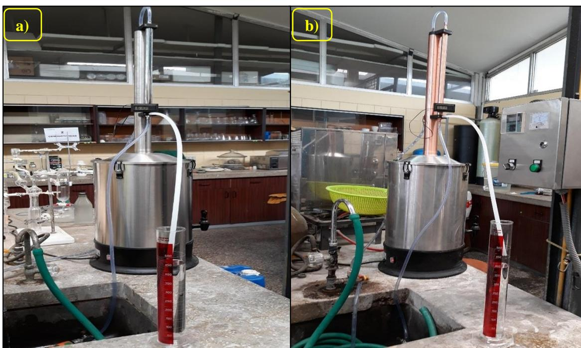
**Figura 16:** a) Destilador Turbo 500 still con condensador T500 columna de acero inoxidable y b) Turbo 500 still con condensador T500 columna de cobre
