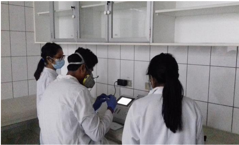
Medición de las características del fucoidano en el espectrofotometro
