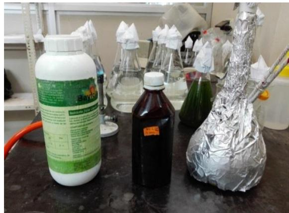
Con ayuda de una pipeta de 5 mL. y una bomba de succión, extraer de 0.5-10 mL(en el caso del experimento de concentración) o 3mL (en el caso del experimento de comparación) del fertilizante a base de residuos de trucha.
