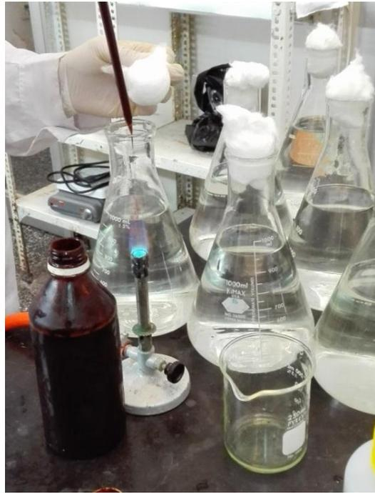
Con una pipeta de 1mL. y una bomba de succión, extraer 0.2mL del medio BAYFOLAN.
