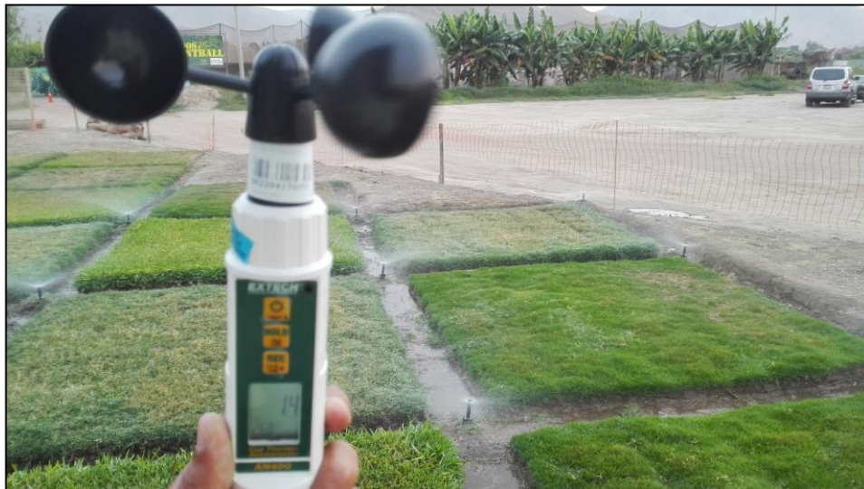
Figura 49: Medición de la velocidad del viento durante el riego de parcelas
