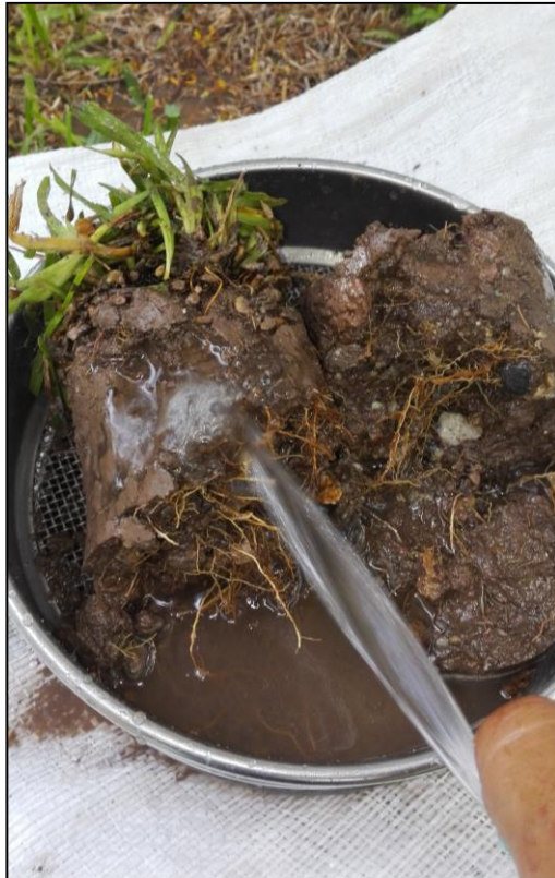
Figura 56: Lavado de suelo para extracción de raíces
