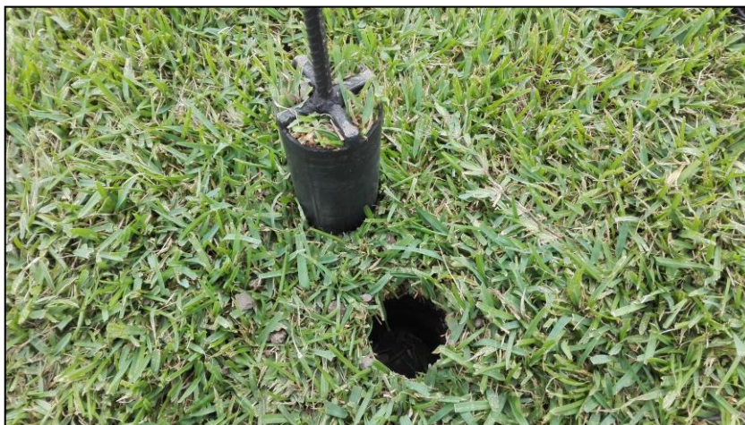
Figura 10: Extracción de suelo para análisis de raíces
