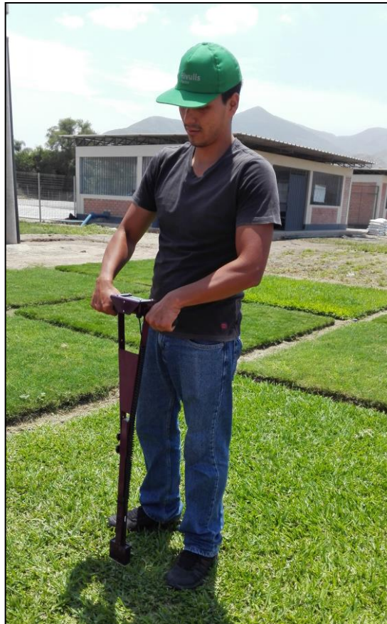
Figura 23: Medición de humedad del suelo con el TDR 300
