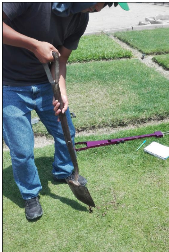
Figura 51: Extracción de suelo para calibración del TDR 300
