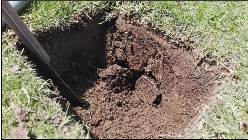
Figura 52: Extracción de muestra de suelo a la profundidad de 20 cm
