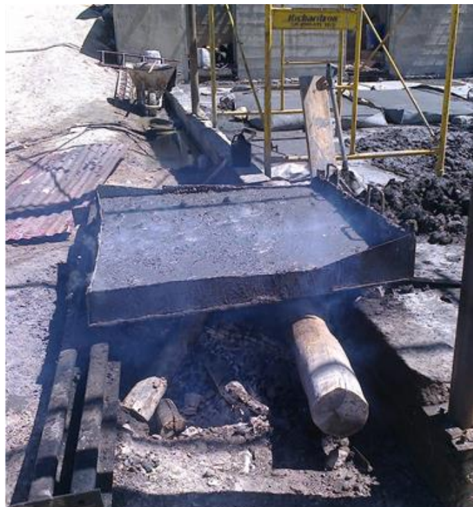
Figura 29: Secado de concentrado aurífero con alto porcentaje de humedad
