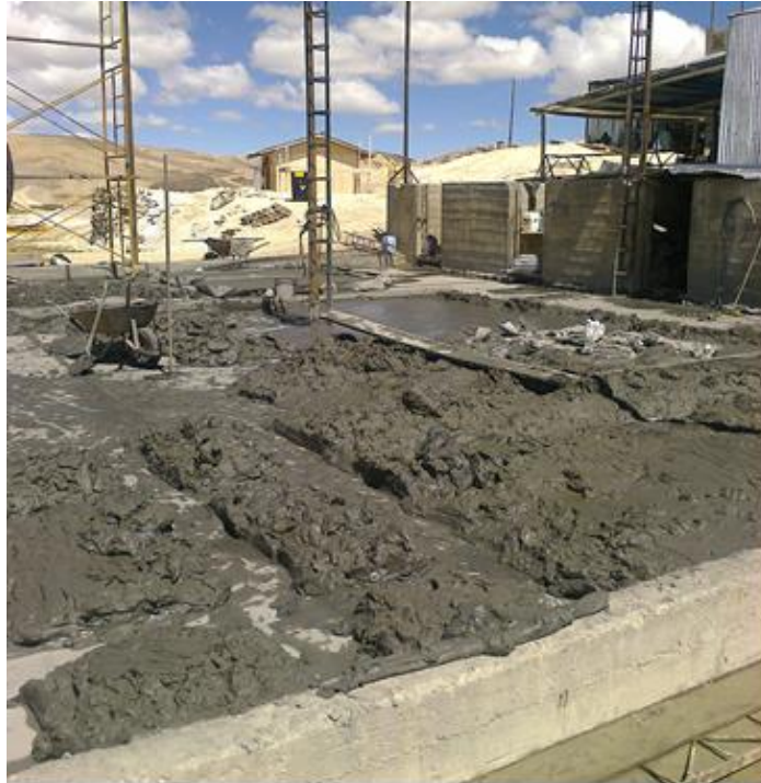
Figura 28: Acumulado de concentrado aurífero con alto porcentaje de humedad
