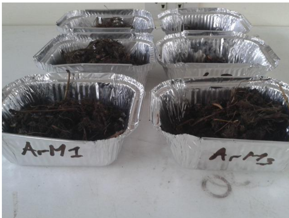
Figura 3: Secado de muestras a estufa para la determinación del porcentaje de humedad y contenido de nitrógeno en compost.
